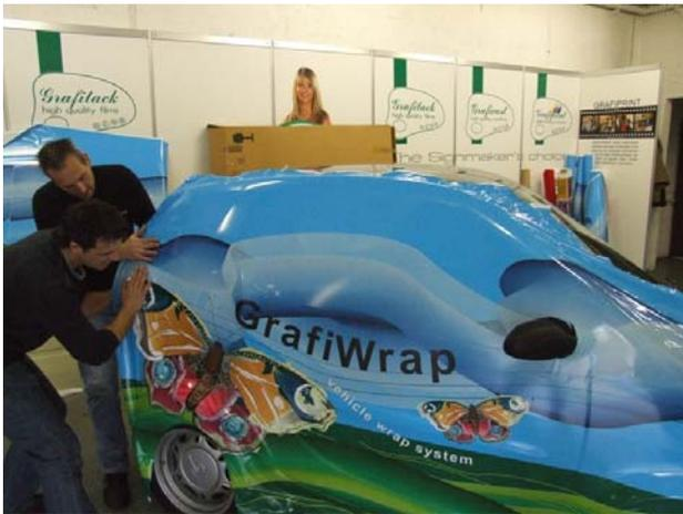
Wenn man die Folie auch über den oberen Rand des Fahrzeuges verkleben will, sollte die Folie auch hier über eine größtmögliche Oberfläche erwärmt werden. Damit verhindern Sie, dass zuviel Spannung auf einer kleinen Fläche aufgebaut wird und die Folie gleichmäßig gedehnt wird. Nach ausreichender Erwärmung kann die Folie über die obere Kante gezogen werden.
