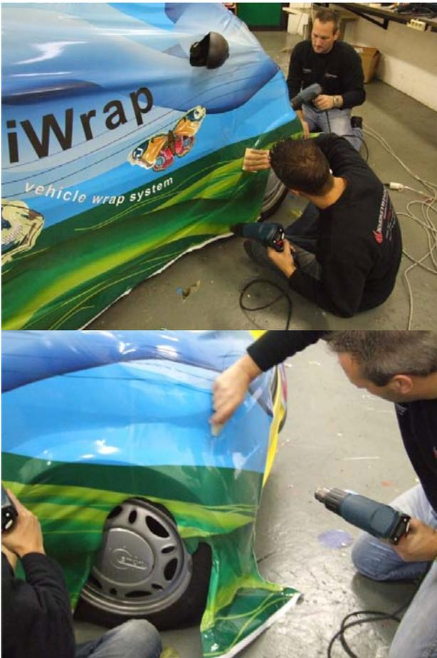
Durch das Erwärmen lässt sich die Folie an schwierigen Stellen leichter montieren, jedoch sollten Sie an den Grundsatz denken, nur dann zu erwärmen, wenn es unbedingt notwendig ist. Achten Sie ebenfalls darauf, dass Sie die Folie während des Aufheizvorgangs nicht bereits dehnen, da sonst das Design an dieser Stelle aus der Form kommen kann.
