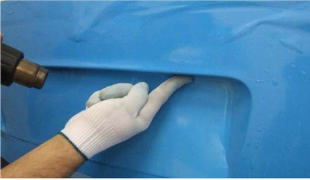
Den mittleren Teil der Folie wird mit dem Filzraker angerakelt. Die Luft aus dem flacheren Bereich kann man über die Öffnungen der entfernten Nummernschildbeleuchtung nach aussen reiben.
