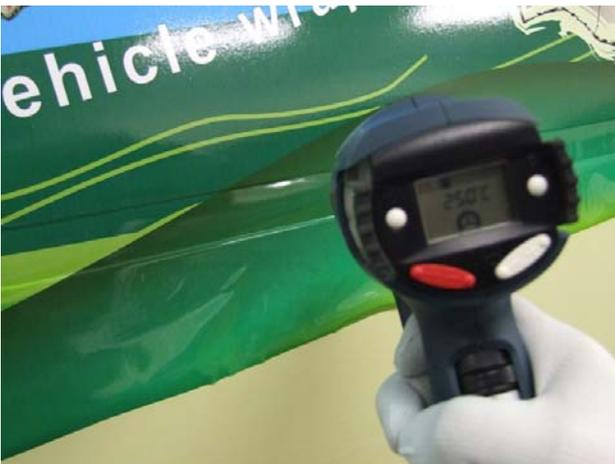
Weiterhin ist es wichtig, dass man die Folie mittels eines speziellen Zubehörs des Heißluftgebläses an der äußeren Vertiefung heizt. Damit erreichen Sie, dass die Folie nicht an der Stelle gedehnt wird, an welcher Sie in die Vertiefung verklebt wird. Die größtmögliche Kleberfläche ist dort, wo man sie benötigt.
