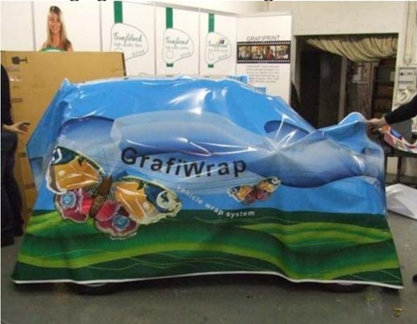
In unserem Beispiel wird die Seitenwand des Fahrzeugs verklebt. Nach der Positionierung schneidet man zunächst ein Loch um den Außenspiegel, insofern man diesen nicht im Vorfeld als störendes Bauteil abgebaut hat. Bitte beachten Sie, dass das Loch gerade mal so groß ist, das der Spiegel hindurchpasst. Sollten Sie das Loch zu groß schneiden, kann Ihnen bei der weiteren Verklebung im Bereich des Spiegels Folie fehlen.
