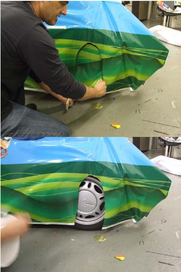
Nachdem man die flachen Seitenteile des Fahrzeuges verklebt hat und mit der Verklebung der Kotflügel und Stossstangen beginnt, heizt man zunächst die Folie mit einer Temperatur von 450°C über eine größtmögliche Fläche auf, um Sie dann über die Rundungen zu ziehen. Aufgrund der Erwärmung lässt sich die Folie gut und leicht dehnen und mit Spannung faltensfrei aufbringen.
